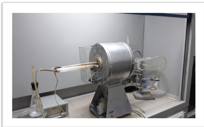
а) сосуды для очистки воздуха; б) лабораторная установка для определения общей серы в нефтепродуктах методом сжигания в трубке
